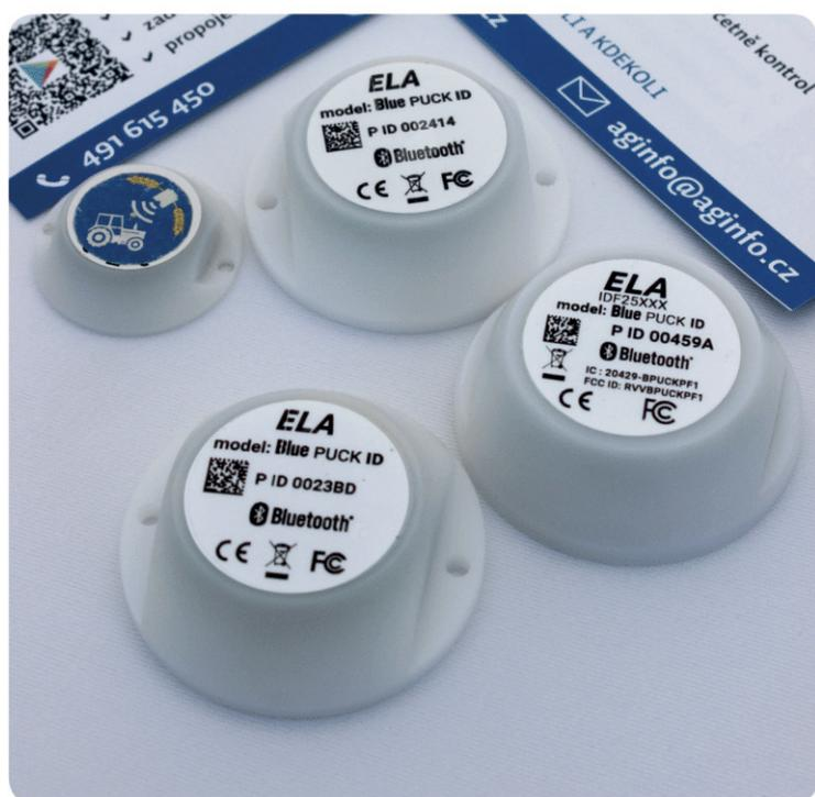
Bezdrátové nedobíjecí puky, které se umísťují na přípojná zařízení, umožňují kontrolovat pohyb takto označených strojů
